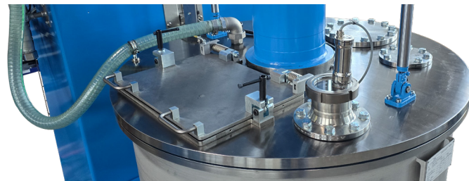
Mischerdeckel mit Handklappe, Beleuchtung und Anschlussstutzen
